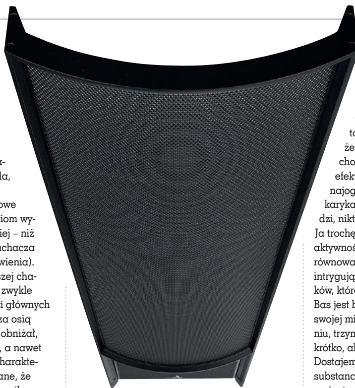
Wygięcie panelu elektrostatycznego pozwala uzyskać lepsze charakterystyki kierunkowe w płaszczyźnie poziomej, zwłaszcza w zakresie wysokich tonów.
